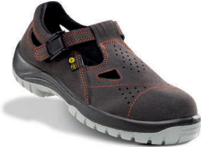
Zapato de piel serraje. Puntera no metálica Vincap. Plantilla antiperforación textil. Suela de poliuretano bidensidad con nivel de deslizamiento SRC.
