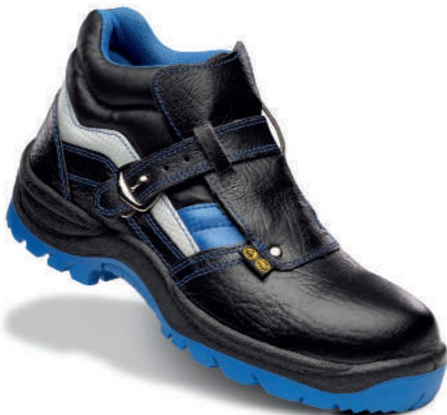
Bota de piel hidrofugada. Cierre con hebilla de desprendimiento rápido. Puntera no metálica Vincap. Plantilla antiperforación textil. Suela de poliuretano bidensidad con nivel de deslizamiento SRC.
