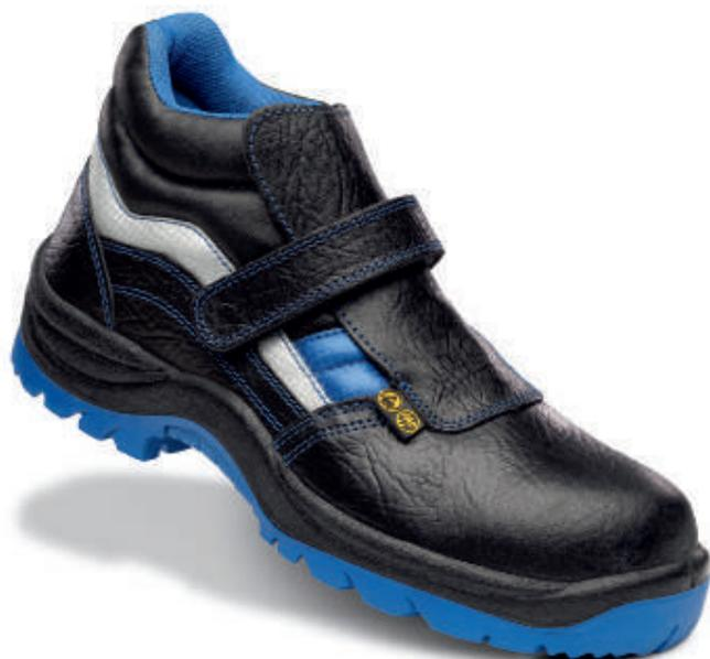
Bota de piel hidrofugada. Cierre marca VELCRO®. Puntera no metálica Vincap. Plantilla antiperforación textil. Suela de poliuretano bidensidad con nivel de deslizamiento SRC.
