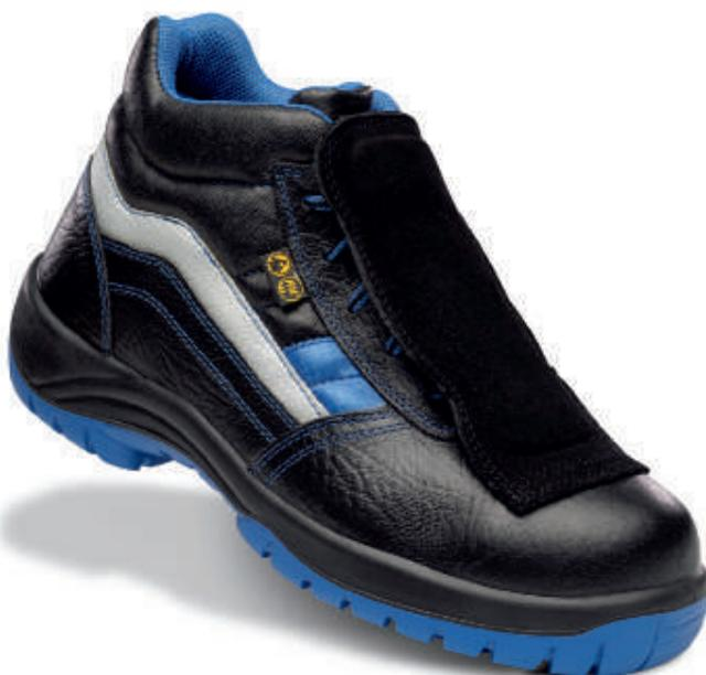
Bota de piel hidrofugada. Protección metatarsal en el empeine. Puntera no metálica Vincap. Plantilla antiperforación textil. Suela de poliuretano bidensidad con nivel de deslizamiento SRC.
