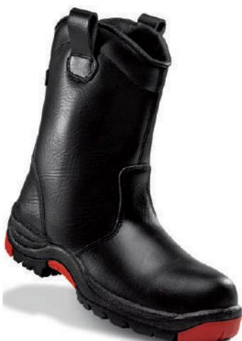
Bota de piel. Puntera no metálica Vincap. Plantilla antiperforación textil. Entresuela de poliuretano. Patín de caucho nitrilo con nivel de deslizamiento SRC.
