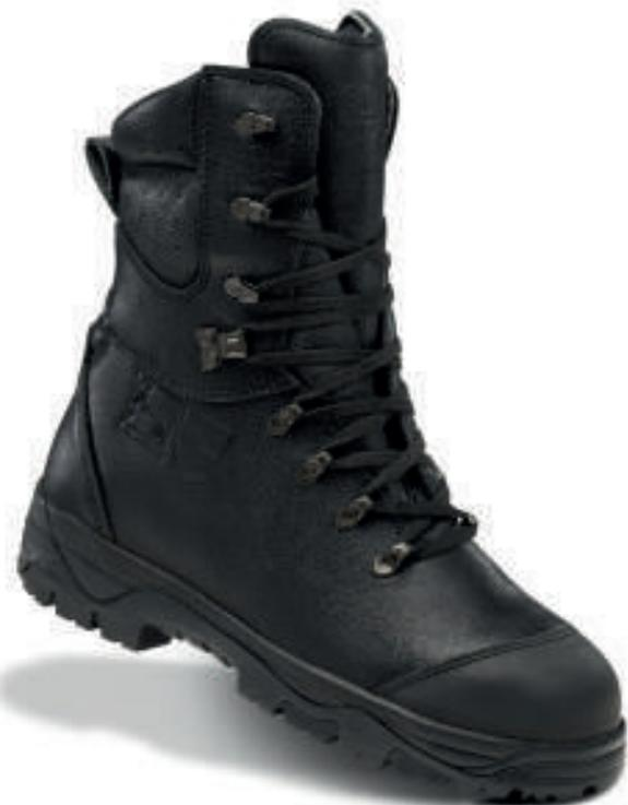
Bota de piel flor hidrofugada e ignifuga. Puntera metálica. Plantilla Antiperforación textil. Suela de caucho nitrilo ignífugo con nivel de deslizamiento SRC.
