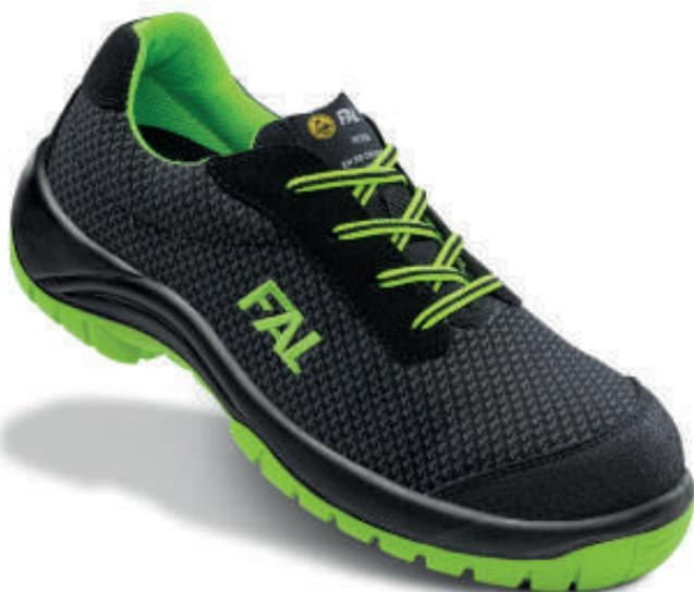
Zapato textil. Puntera no metálica Vincap. Plantilla antiperforación textil. Suela de poliuretano bidensidad con nivel de deslizamiento SRC.
