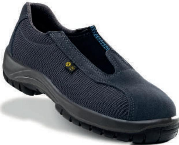
Zapato textil hidrofugado tipo cordura, serraje y lycra. Puntera no metálica Vincap. Plantilla antiperforación textil. Suela de poliuretano bidensidad con nivel de deslizamiento SRC.
