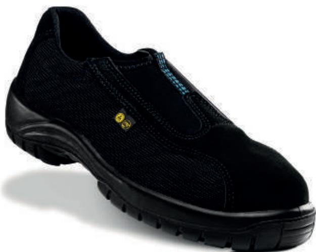
Zapato textil hidrofugado tipo cordura, serraje y lycra. Puntera no metálica Vincap. Plantilla antiperforación textil. Suela de poliuretano bidensidad con nivel de deslizamiento SRC.
