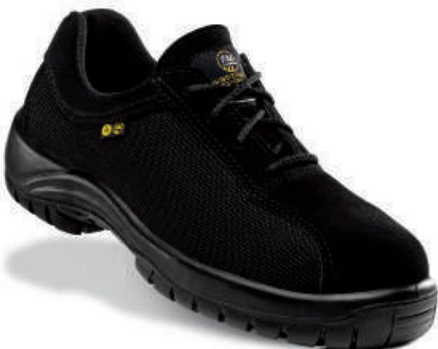
Zapato textil hidrofugado tipo cordura y serraje. Puntera no metálica Vincap. Plantilla antiperforación textil. Suela de poliuretano bidensidad con nivel de deslizamiento SRC.
