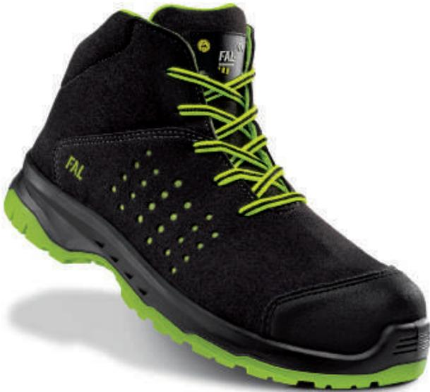
Bota de microfibra hidrofugada. Puntera no metálica Vincap. Plantilla antiperforación textil. Suela de poliuretano bidensidad con nivel de deslizamiento SRC.
