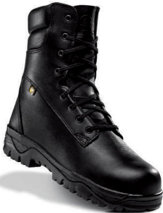
Bota de piel flor hidrofugada e ignifuga. Puntera no metálica Vincap. Plantilla Antiperforación textil. Suela de caucho nitrilo ignífugo con nivel de deslizamiento SRC.
