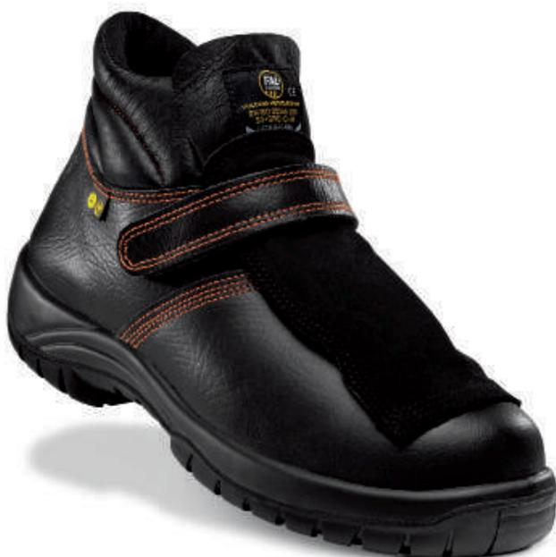
Bota de piel hidrofugada. Cierre marca VELCRO®. Puntera no metálica Vincap. Plantilla antiperforación textil. Suela de poliuretano bidensidad con nivel de deslizamiento SRC. Protección metatarso.
