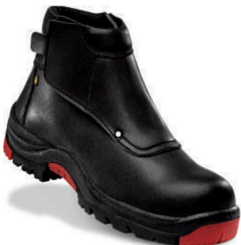
Bota de microfibras resistente a soldadura. Cierre marca VELCRO®. Puntera no metálica Vincap. Plantilla antiperforación textil. Entresuela de poliuretano. Patín de caucho nitrilo con nivel de deslizamiento SRC.
