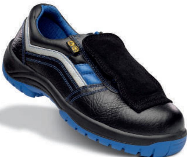
Zapato de piel hidrofugada. Protección metatarsal en el empeine. Puntera no metálica Vincap. Plantilla antiperforación textil. Suela de poliuretano bidensidad con nivel de deslizamiento SRC.
