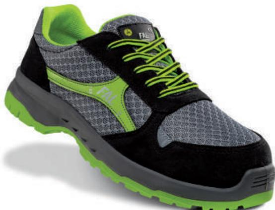
Zapato textil hidrofugado. Puntera no metálica Vincap. Plantilla antiperforación textil. Suela de poliuretano bidensidad con nivel de deslizamiento SRC.
