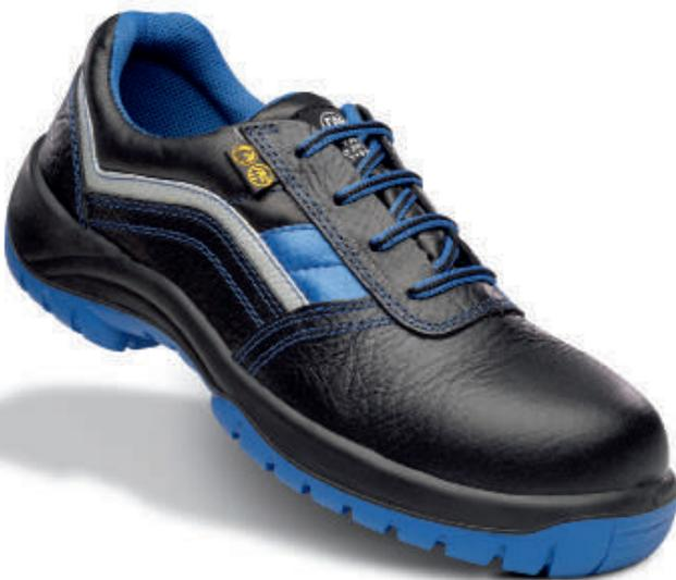
Zapato de piel hidrofugada. Puntera no metálica Vincap. Plantilla antiperforación textil. Suela de poliuretano bidensidad con nivel de deslizamiento SRC.
