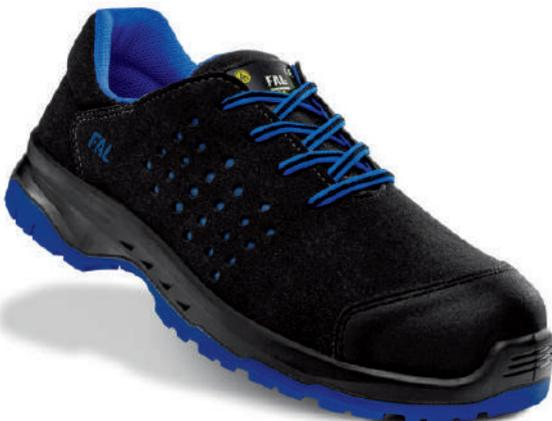
Zapato de microfibra hidrofugada. Puntera no metálica Vincap. Plantilla antiperforación textil. Suela de poliuretano bidensidad con nivel de deslizamiento SRC.
