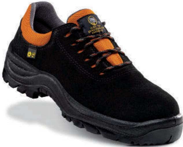
Zapato de piel serraje y textil tipo cordura hidrofugados. Puntera no metálica Vincap. Plantilla antiperforación textil. Suela de poliuretano bidensidad con nivel de deslizamiento SRC.
