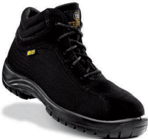
Bota textil hidrofugada tipo cordura y serraje. Puntera no metálica Vincap. Plantilla antiperforación textil. Suela de poliuretano bidensidad con nivel de deslizamiento SRC.
