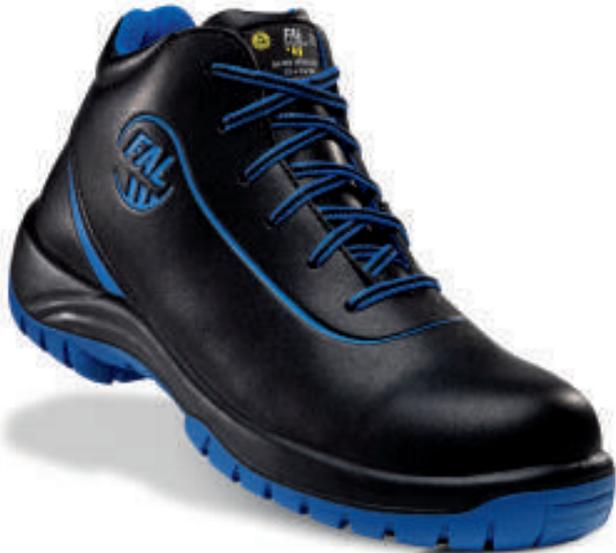
Bota de microfibras resistente a la soldadura. Puntera no metálica Vincap. Plantilla antiperforación textil. Suela de poliuretano bidensidad con nivel de deslizamiento SRC.
